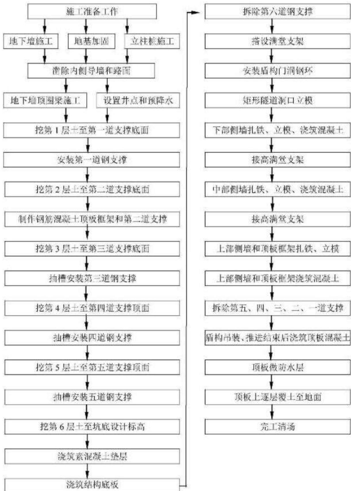
图 2-1-14 工作井施工流程示意图
