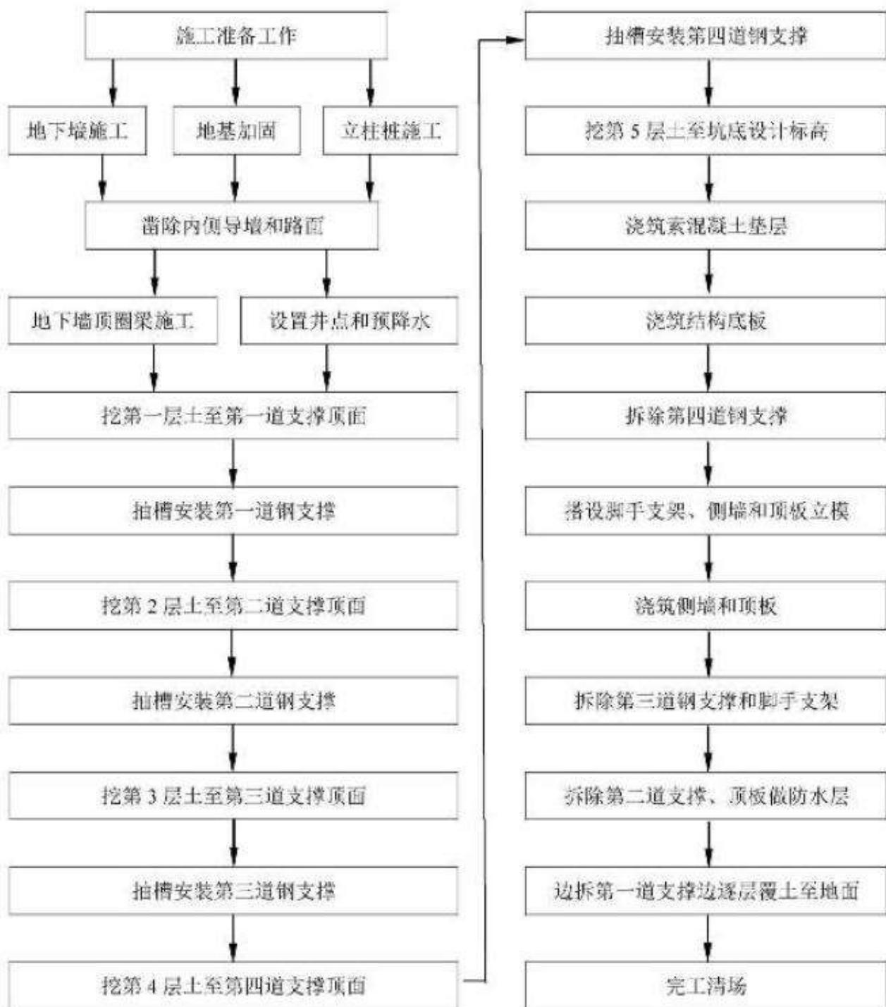
图 2-1-15 暗埋段施工流程示意图
