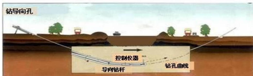
图 3.2.1-5 钻导向孔示意图
