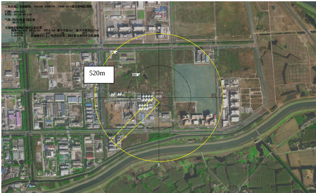
图 6.7-8 最常见气象条件下烷基苯磺酸泄漏火灾伴生/次生 SO 2 扩散影响示意图
