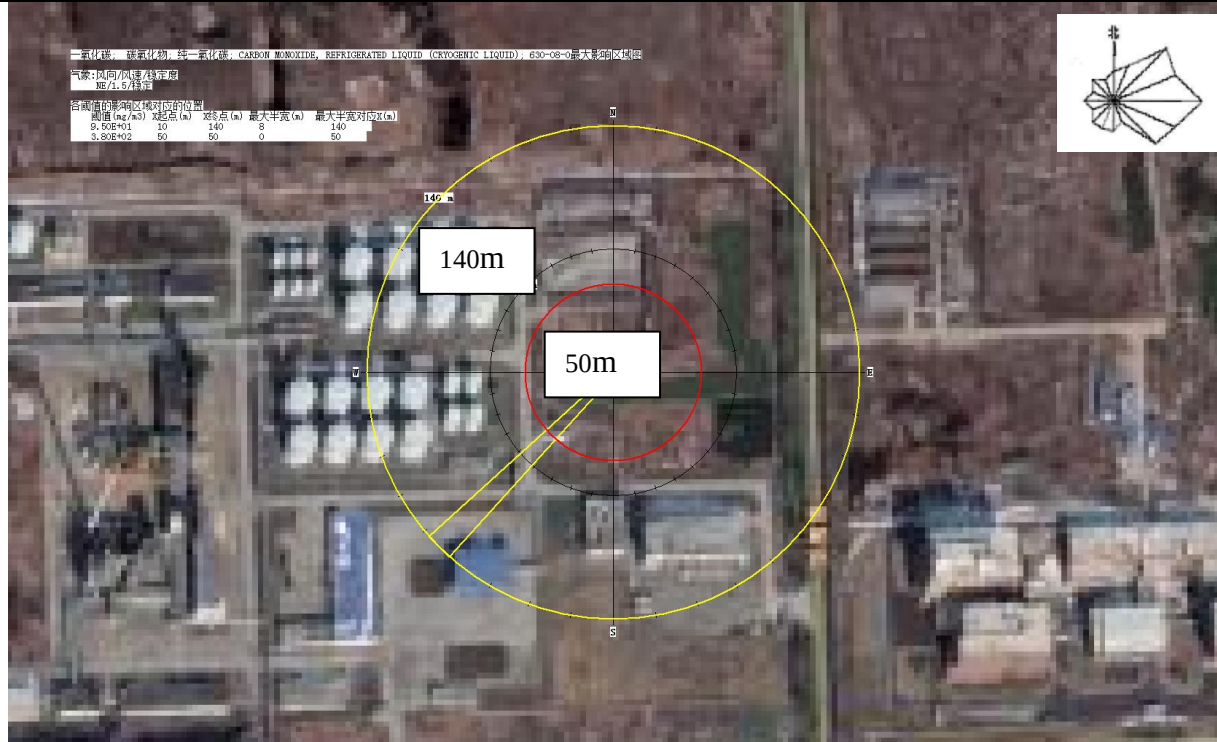
图 6.7-5 最不利气象条件下烷基苯磺酸泄漏火灾伴生/次生 CO 扩散影响示意图
