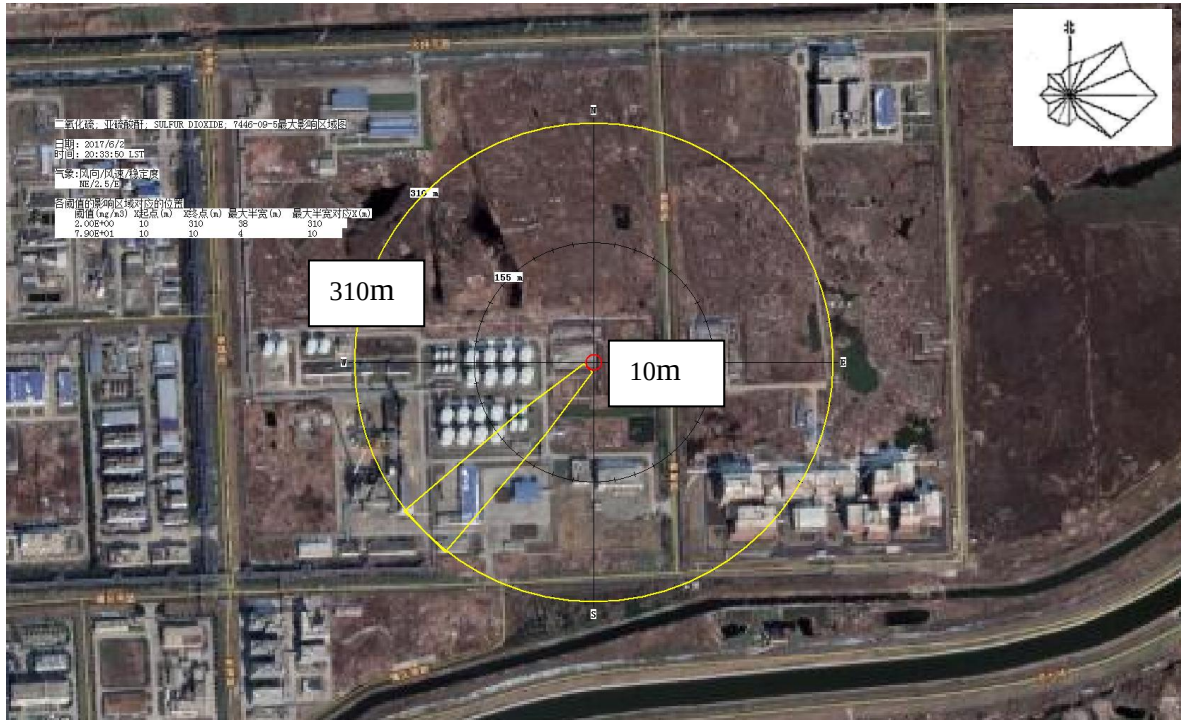
图 6.7-2 最常见气象条件下磺化装置燃硫炉发生泄漏 SO 2 扩散影响示意图
