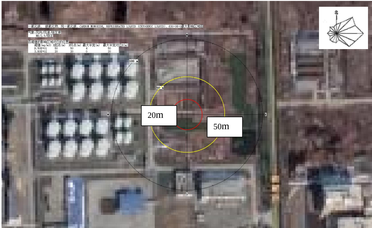
图 6.7-6 最常见气象条件下烷基苯磺酸泄漏火灾伴生/次生 CO 扩散影响示意图
