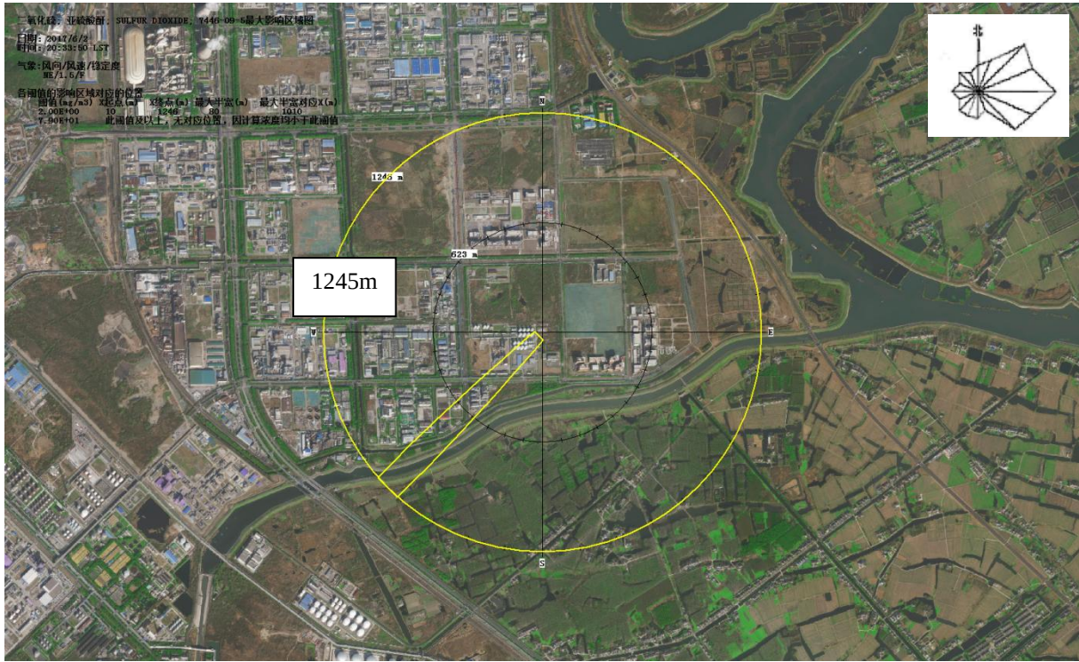
图 6.7-7 最不利气象条件下烷基苯磺酸泄漏火灾伴生/次生 SO 2 扩散影响示意图
