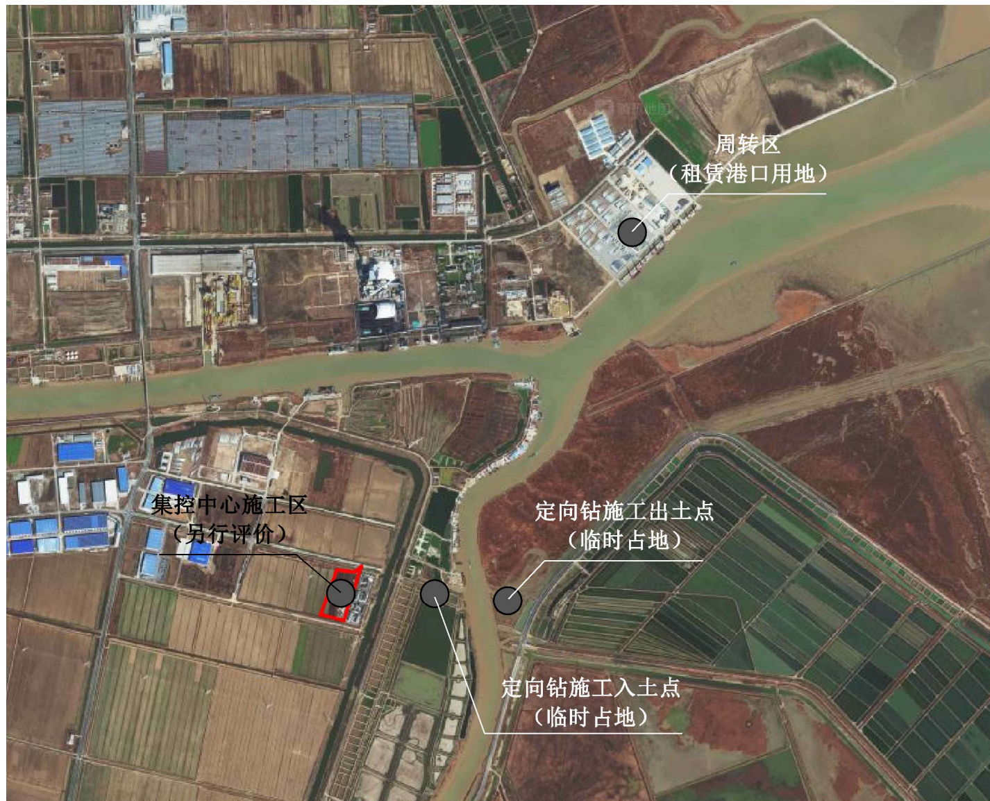
图 2.4-3 风电项目施工总布置图
