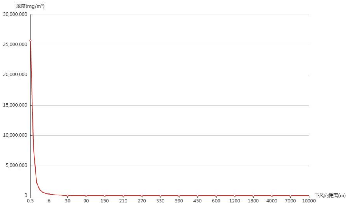
图 6.8-13 甲醇储罐甲醇泄露下风向距离浓度曲线图（最不利气象条件下）
