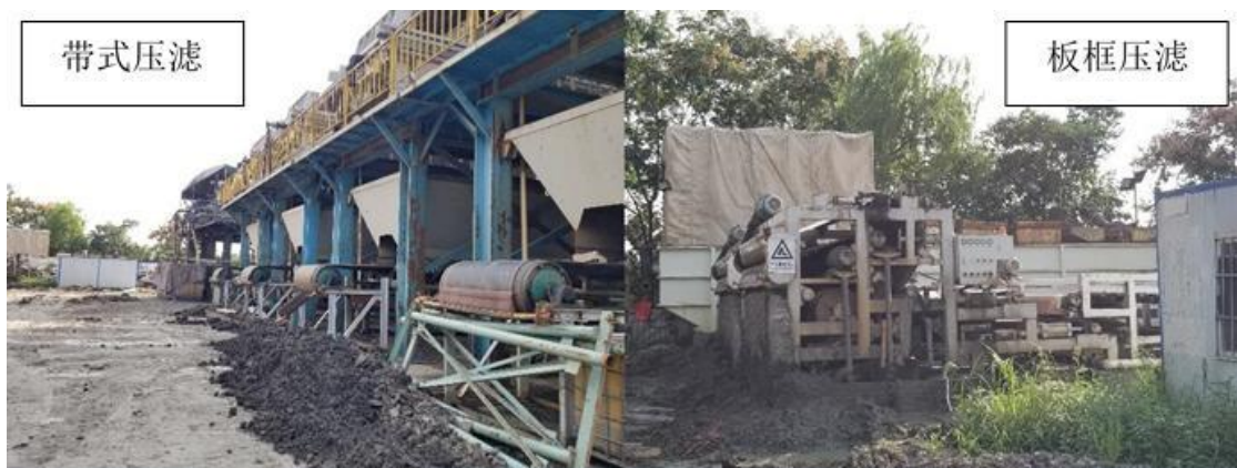
图 3.2-9 机械压滤脱水法示意图
