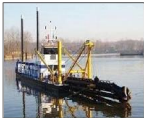
图 3.2-3-2 绞吸式挖泥船
