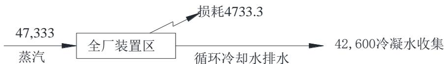
图 3.1-4 现有项目蒸汽平衡图（单位：t/a）
