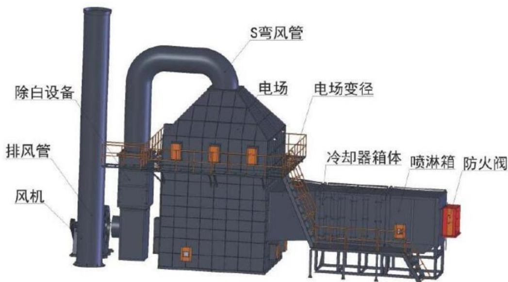
图7.2-3 “水喷淋+静电除油”设备示意图
