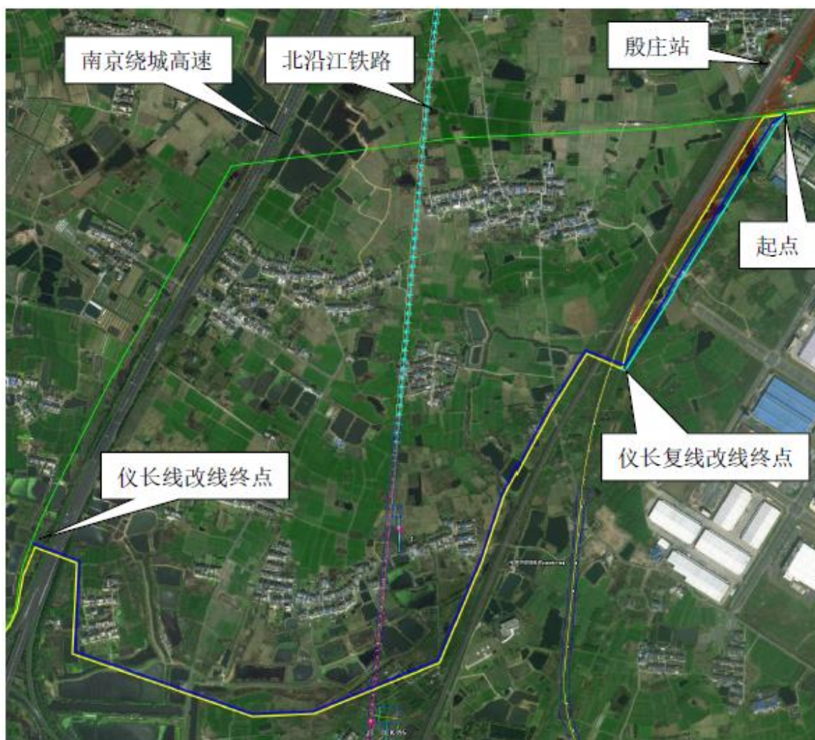
图 3.2-2 方案二路由示意图（绿色线为既有仪长线；黄色线为既有仪长复线；深蓝色线为仪长线迁改路由；青色线为仪长复线迁改路由）
