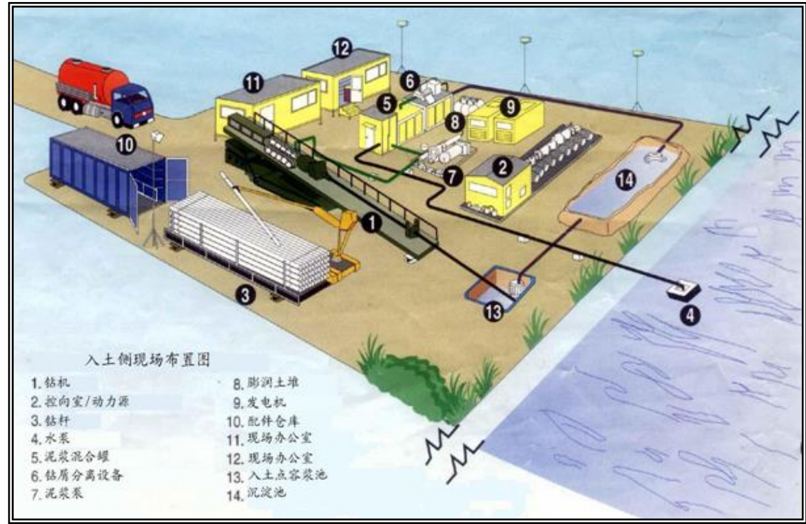
图 3.3-14 定向钻入土点平面布置示意图
