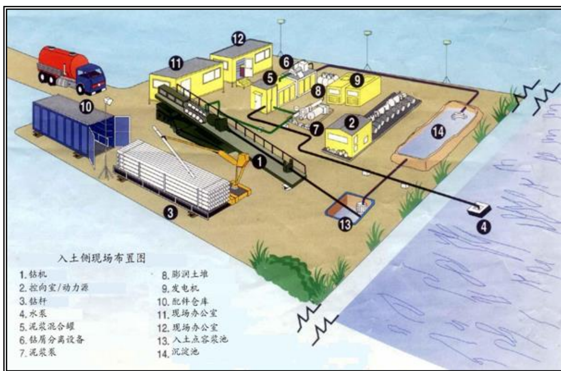
图 3.3-12 定向钻入土点平面布置示意图
