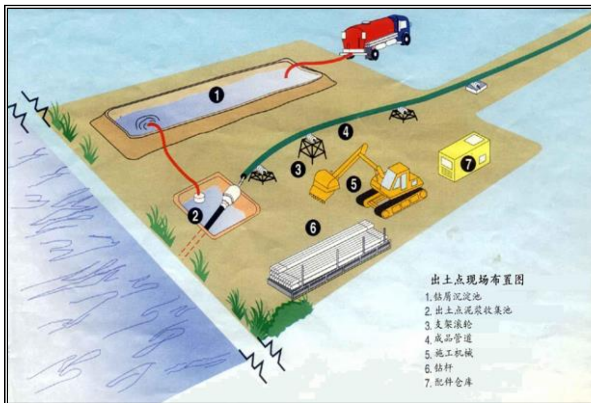
图 3.3-13 定向钻出土点平面布置示意图
