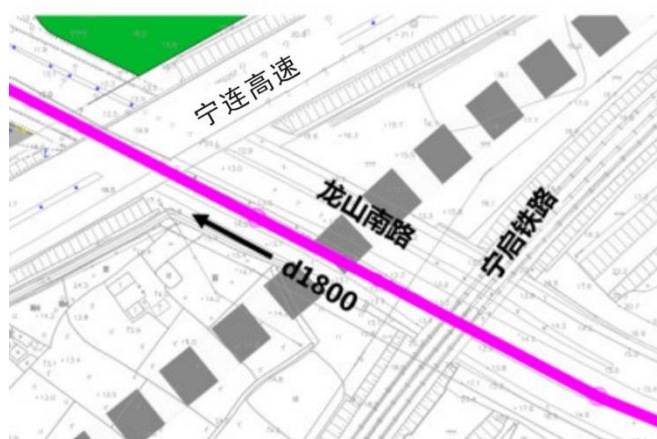
图 5-4 管道穿越宁启铁路、宁连高速节点
