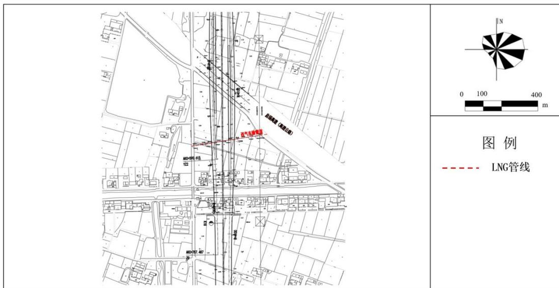
图 3.3.9 (1) LNG 管线示意图
