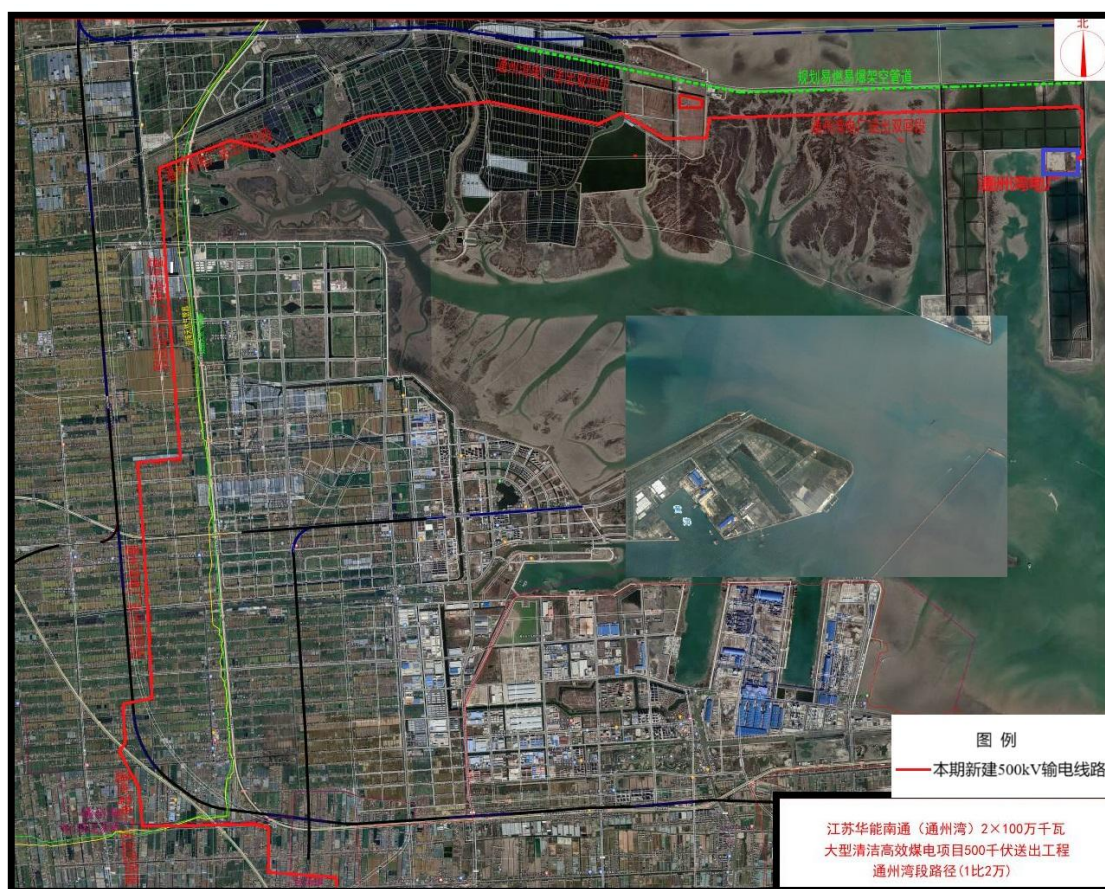
图 3.4 通州湾段线路路径方案示意图
