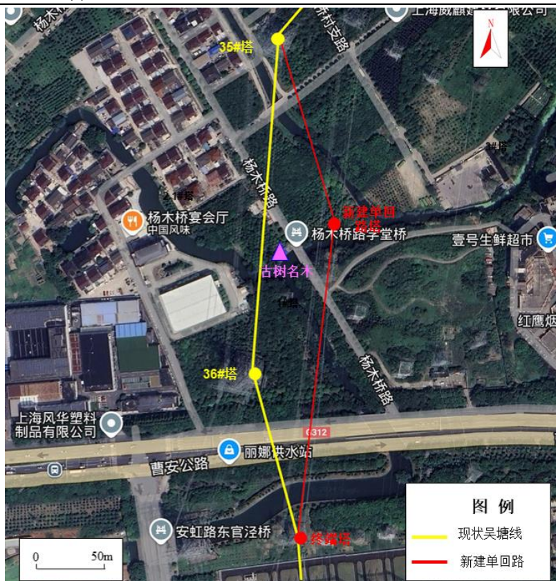
图 3.2-1 东吴~黄渡 500kV 双回线路改造工程古树名木段方案比选示意图
